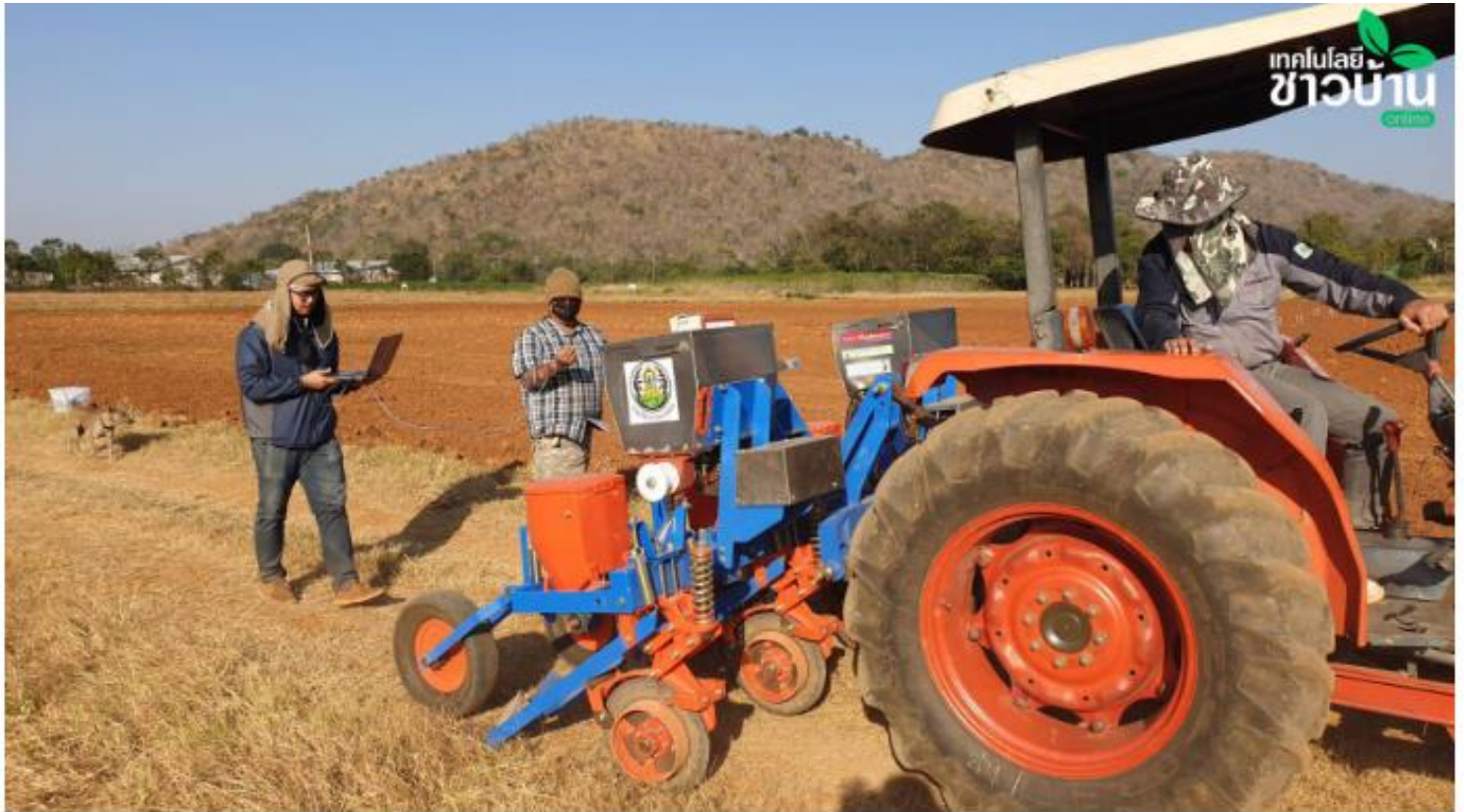
การทดสอบความแม่นยำของเซ็นเซอร์วัดระยะและความเร็วการเคลื่อนที่ของเครื่องหยอดฯ
