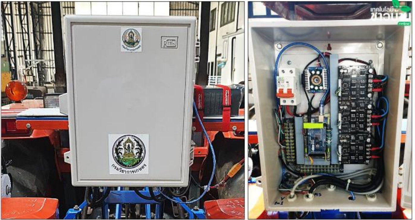
ตู้ควบคุมอัตราการหยอดเมล็ดพืชและปุ๋ยแบบอัตโนมัติด้วยสมองกลฝังตัว
