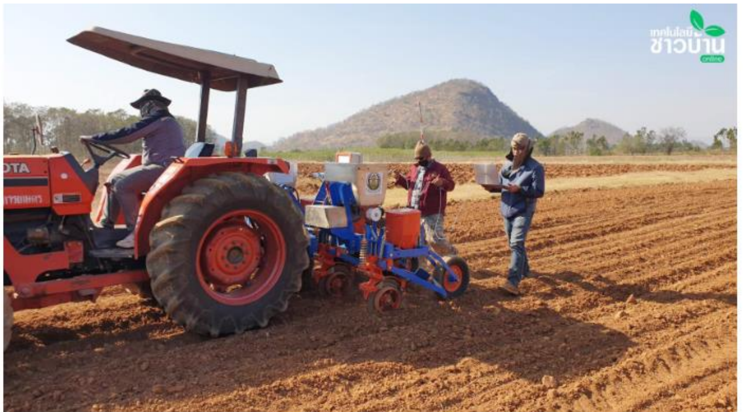
การทดสอบความแม่นยำของการควบคุมอัตราการหยอดเมล็ดและปุ๋ยด้วยโปรแกรมคอมพิวเตอร์
