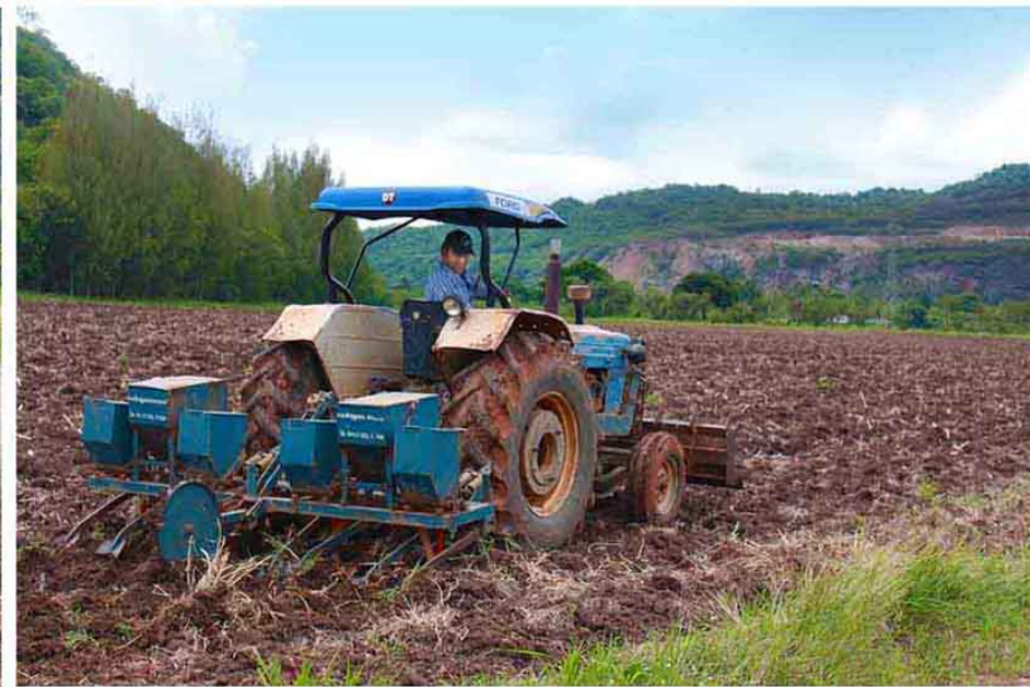
ประยุกต์ใช้เครื่องจักรลดแรงงานคน หยอดเมล็ดข้าวโพด ใส่ปุ๋ยและฉีดพ่นยา
