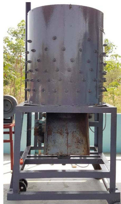
รูปที่ 5 เครื่องตีทะเลลายปาล์มที่ใช้ในการทดสอบตี ทะเลลายปาล์มหลังการอบด้วยความเร็วรอบในการตีคือ 80 รอบต่อนาที
