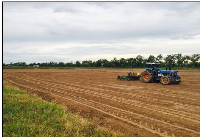
การปรับระดับดินนา โดยเครื่องจักรกลปรับระดับดินนาด้วยแสงเลเซอร์
