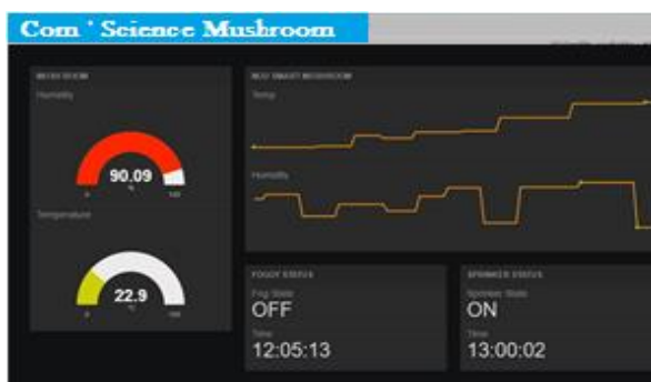
ภาพที่ 7 แสดงข้อมูลค่าความชื้นของโรงเปิดดอกเห็ดนางฟ้าแสดงผลทุกๆ 5 นาทีแบบเรียลไทม์
