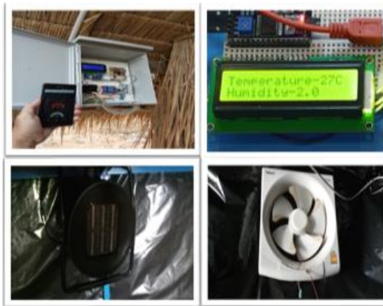
ภาพที่ 5 แสดงชุดเซ็นเซอร์ที่ใช้ในการควบคุมโรงเรือนเพาะเห็ดเห็นนางฟ้า
