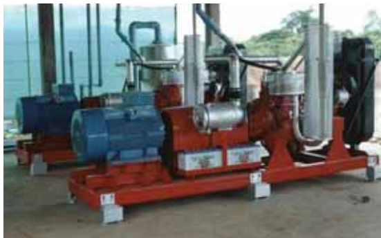
รูปที่ 3-31 เครื่องยนต์ดีเซลดัดแปลงให้ใช้ก๊าซชีวภาพแทนได้ทั้งหมดต่อร่วมกับ Synchronous/Induction Generator เพื่อผลิตไฟฟ้า
