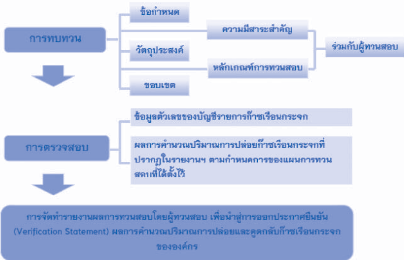
รูปที่ 3 ขั้นตอนการทวนสอบขององค์กรปกครองส่วนท้องถิ่น
